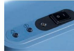
Panel de interfaz con interruptor de encendido/apagado e indicadores de alarma
